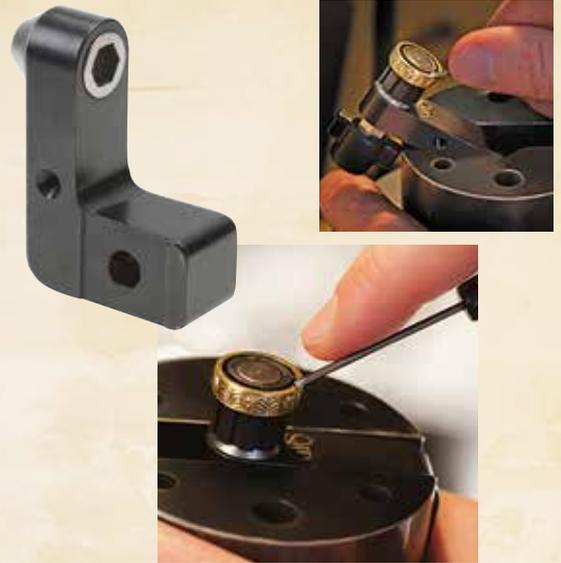
Με αυτό το στήριγμα μπορείτε να επιτύχετε μεγαλύτερη ελευθερία κατά την εγχάραξη δαχτυλιδιών στην εξωτερική πλευρά ή πάνω στην ακμή του δαχτυλιδιού. Αυτό το στήριγμα μπορεί να στερεωθεί υπό διάφορες γωνίες σε μια μέγγενη. Οι ρυθμιστικοί κοχλίες βοηθούν στη στερέωση του στηρίγματος στη μέγγενη ή, μπορούν και να αφαιρεθούν για μεγαλύτερη ελευθερία κινήσεων.
