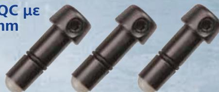
Μπορείτε να αλλάξετε τη δύναμη κρούσεων των εργαλείων χειρός GRS, απλώς τοποθετώντας ένα εργαλείο ή ένα καλέμι σε αυτό το νέο στήριγμα εργαλείων QC με αποσβεστήρα. Καθώς στο άκρο του στήριγματος εργαλείων QC υπάρχει προσαρτημένο ένα ειδικό πλαστικό πώμα, η ενέργεια από το εργαλείο χειρός μεταδίδεται πιο ήπια στο εργαλείο και έτσι, η κρούση είναι μικρότερης έντασης.
